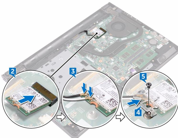
**4** Odprtino za vijak na nosilcu brezžične kartice poravnajte z odprtino za vijak na brezžični kartici in sistemski plošči.
